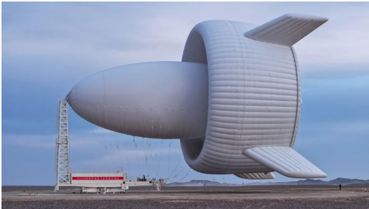
Первая в мире летающая ветряная электростанция мощностью 1 МВт Источник: https://share.google/HBFkfUyHobxmuVRUL
